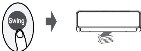
Ако продължите да натискате бутона SWING, може да настроите пет различни посоки на потока. Жалуза може да се движи в определен диапазон при всяко натискане на бутона. Натискайте бутона, докато се достигне посоката, която предпочитате.
